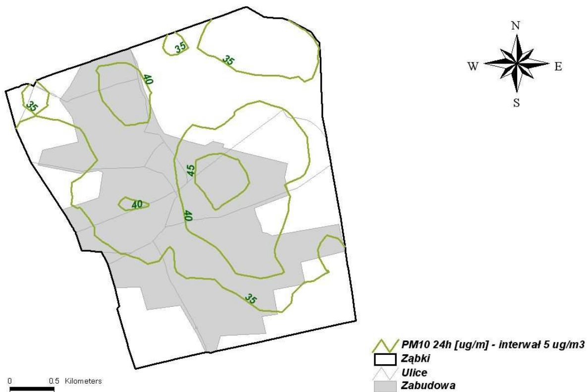
Rysunek 7.13 Rozkład stężeń pyłu zawieszonego PM10 o okresie uśredniania wyników pomiarów 24 godziny, powodowanych emisją całkowitą, po zrealizowaniu działania naprawczego na terenie Zabek.
