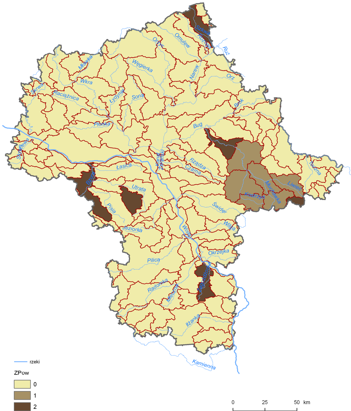
Rys. 2.16. Ocena potrzeb zwiększania retencyjności scalonych części wód pod względem powierzchni obszarów intensywnie zagospodarowanych znajdujących się w strefie zalewów powodziowych (ZPow) 2 – wysoki priorytet, 1 – średni priorytet, 0 – niski priorytet
