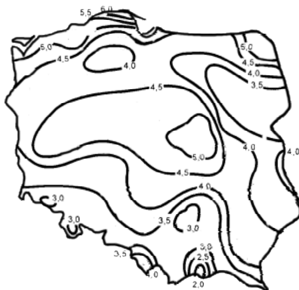
Rys. 1 Mapa zasobów wiatru wg pomiarów IMGW na wysokości 30 m n.p.g. dla terenu o klasie szorstkości „0-1
